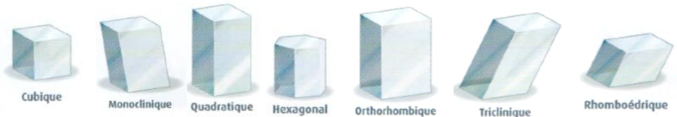
On décrit la maille d'un cristal par sa forme, mais également par la disposition des entités chimiques au sein de la maille, que l'on appelle **le réseau cristallin** :
